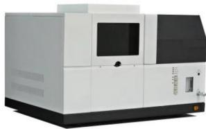
El espectrofotómetro de absorción atómica 5800 es un modelo modificado basado en 7800. Es un Espectrofotómetro de absorción atómica de llama económico con alto rendimiento, fácil operación, medición precisa y funciones estables. Cumple con el requisito de limitado presupuesto y es bien recibido por una gran cantidad de usuarios.
